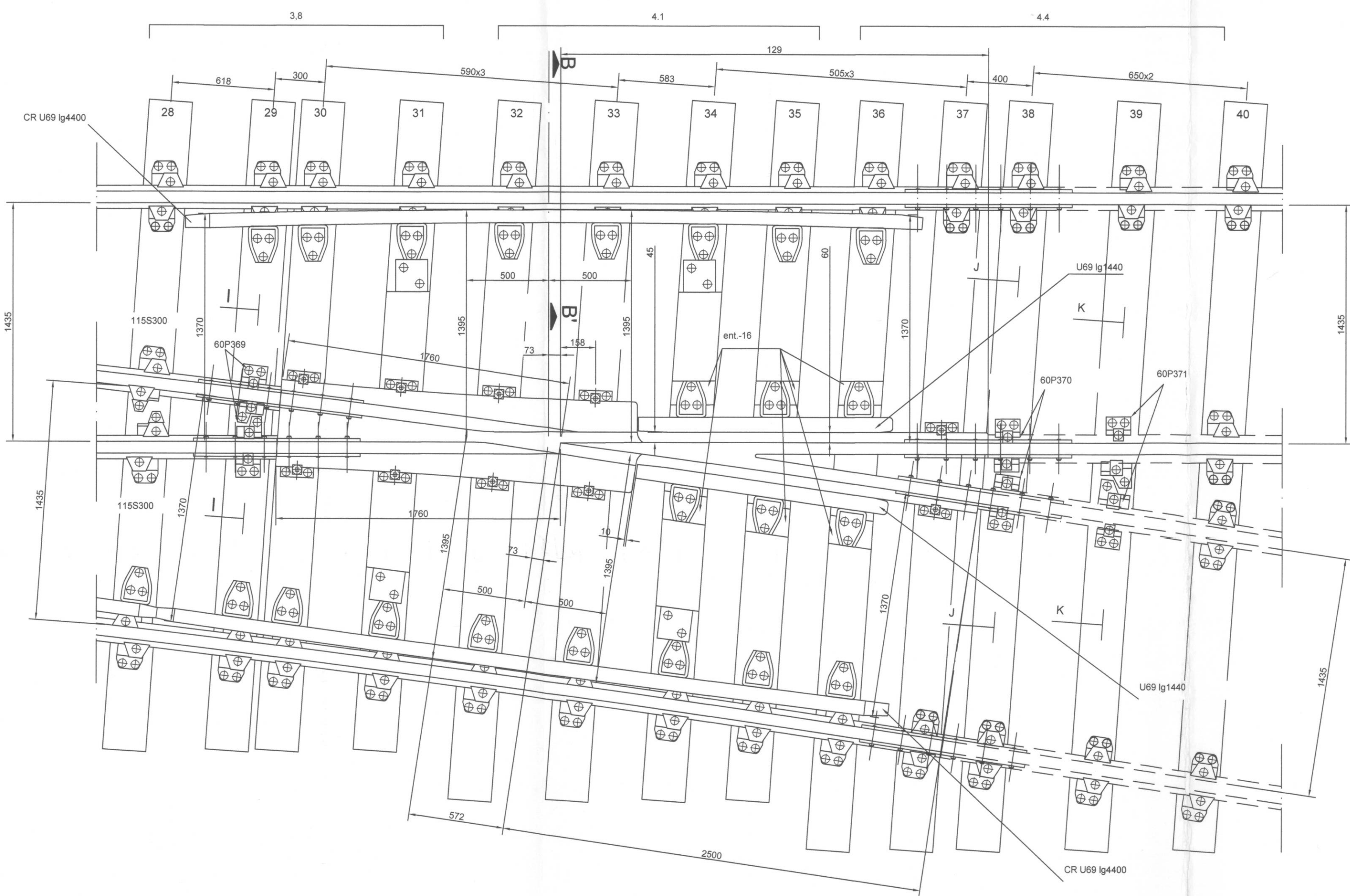
VIA DE 1435 - CON INCLINACION 1/20 RIEL 115 R.E. CRUZAMIENTO Tg 0,13 A DERECHA PLANO DE CONJUNTO ESCALA 1:20
