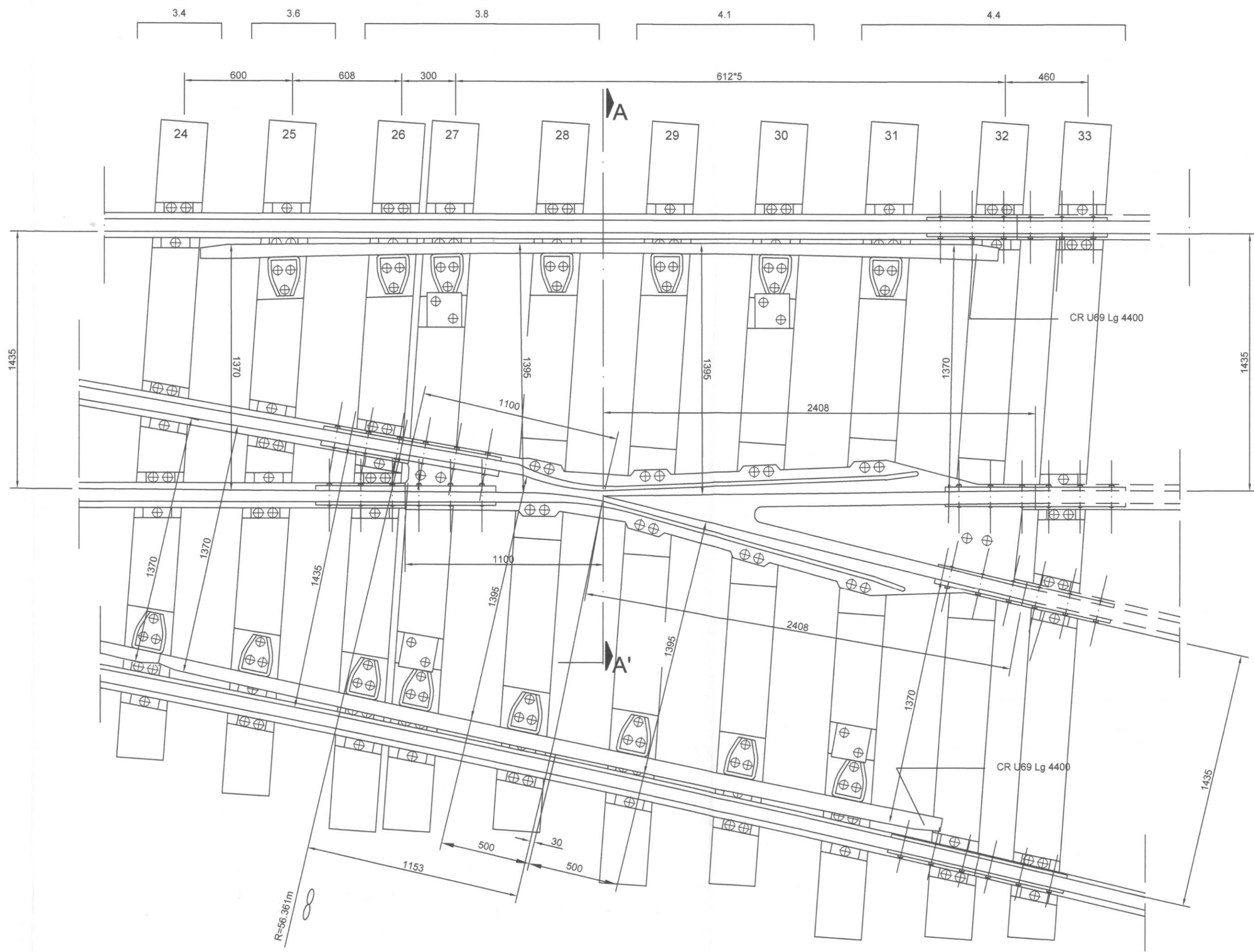
VIA DE 1435 CON RIELES 115 R.E. CRUZAMIENTO A DERECHA TG0,20 Ensamble ESCALA 1:20
