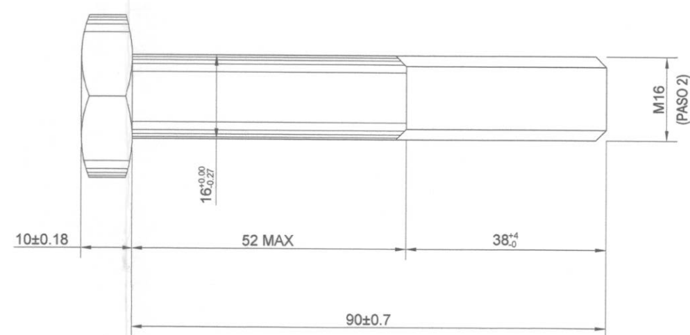
TORNILLO HM16 MATERIAL: ACERO A.S.T.M. A-325 A.R. TIPO I S/E
